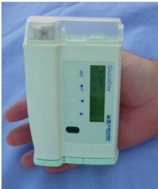
εικόνα 2.2.5 Glucoday S (Menarini). Σύστημα συνεχούς καταγραφής γλυκόζης αίματος.
